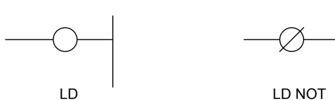
Gambar 8. Simbol logika LOAD dan LOAD NOT.
