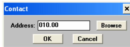
10. Isikan alamat yang sama dengan *output* yaitu 01.00. *open contact* disini berfungsi sebagai *internal relay* sebagai proses *latching* atau *self holding*.
